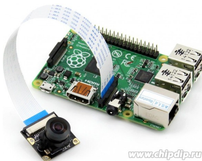
3.3-сурет – Raspberry Pi 3B+ құрылғысына RPi Camera қосылуы [46]
